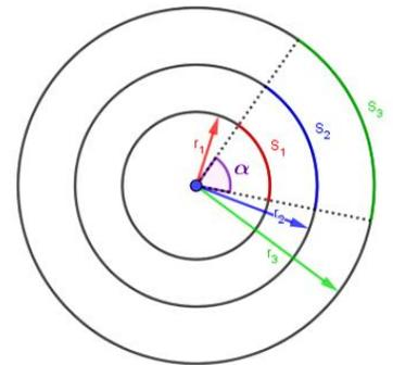
$$\hat{\alpha} \text{ (en radianes)} = \frac{S_1}{r_1} = \frac{S_2}{r_2} = \frac{S_3}{r_3}$$
